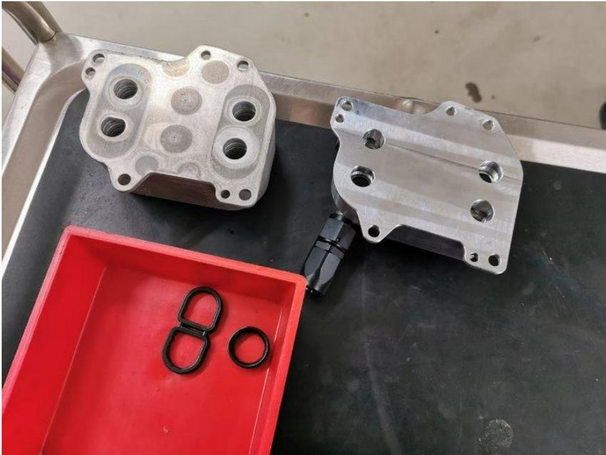
3. Nun wird das Ölfiltergehäuse wieder an den Motorblock festgeschraubt. Wichtig ist es, dass die 2 Banjo Anschlüsse auf dem Flansch noch nicht angezogen werden.
