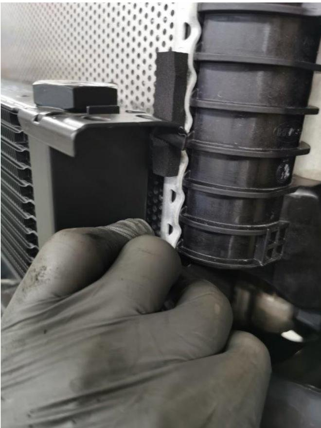
10. Es ist sehr wichtig den Ölkühler jetzt mit Öl zu befüllen, da sonst ein Motorschaden riskiert wird.
