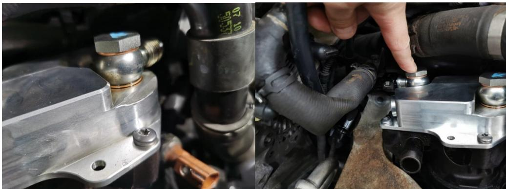
4. Jetzt muss der Halter vom vorderen Motorlager wieder am Motorblock verschraubt werden, dieser Schritt ist sehr wichtig da die obere Schraube später verdeckt ist und es dann unmöglich ist diese fest zu ziehen.
