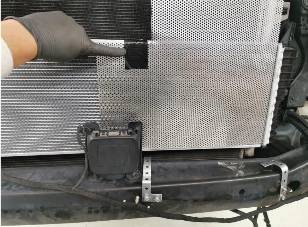
9. Um den Ölkühler vor Beschädigungen zu schützen muss jetzt das Moosgummi auf die Unterfläche und auf die hintere obere Kante geklebt werden. Danach kann man den Ölkühler auf den Haltern festschrauben.
